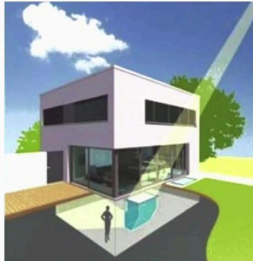
Beispiel eines Lichtschachtes mit Reflektor
