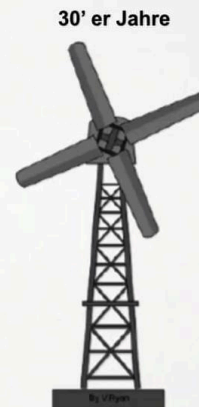
Palmer-Putman Turbine 1,26 MW Elektrizität Rotordurchmesser: 50 m
