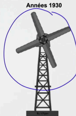
Turbine Palmer-Putman 1,26 MW électricité Diamètre rotor: 50 m
